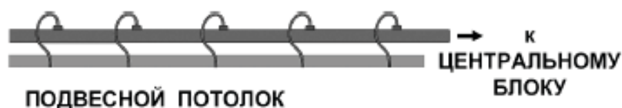
Рис. 29. Установка воздухозаборной трубы за подвесным потолком
