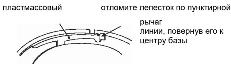
**Рис. 1** Активация функции защиты от несанкционированного извлечения извещателя
